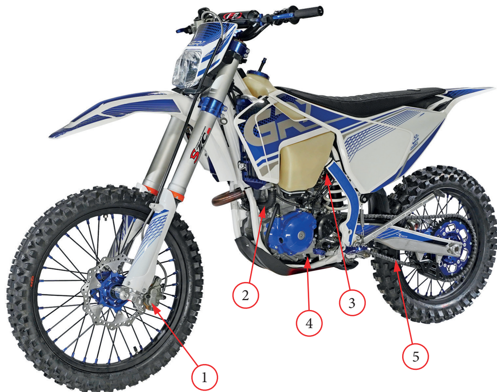
Фото 4.2.1. Узлы и механизмы с левой стороны (мотоцикл с инжектором): 1 - суппорт переднего тормоза; 2 - патрубки радиатора; 3 - воздушный фильтр; 4 - место размещения болта слива масла; 5 - приводная цепь
