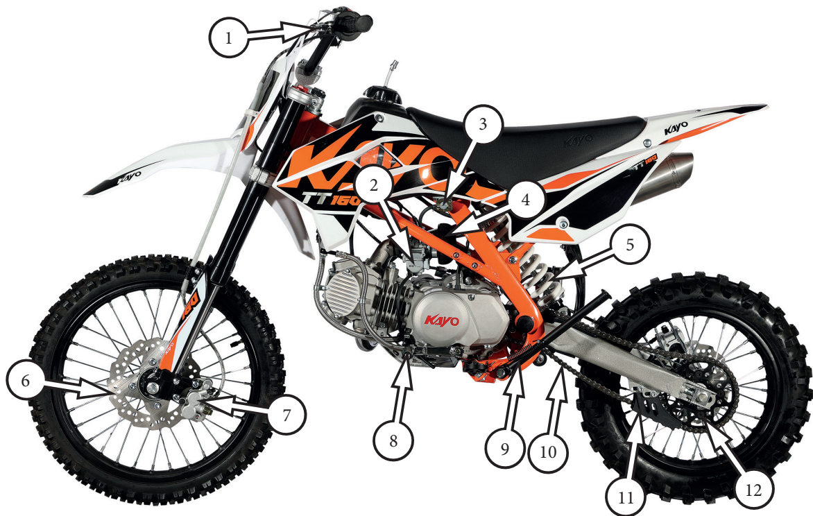
Фото 2.1 Левая сторона питбайка: 1 – рычаг сцепления; 2 – карбюратор; 3 – топливный кран; 4 – воздушный фильтр; 5 – задний амортизатор; 6 – передний тормозной диск; 7 – передний тормозной суппорт; 8 – рычаг переключения передач; 9 – боковая подставка; 10 – приводная цепь; 11 – слайдер-уловитель цепи; 12 – задняя звездочка
