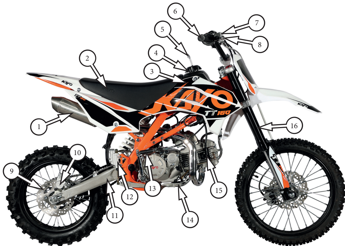
Фото 2.2 Правая сторона питбайка: 1 – глушитель; 2 – сиденье; 3 – топливный бак; 4 – крышка бака; 5 – вентиляционная трубка; 6 – ручка акселератора (газа); 7 – передний бачок тормозной жидкости; 8 – рычаг переднего тормоза; 9 – задний тормозной диск; 10 – задний тормозной суппорт; 11 – задний маятник; 12 – задний тормозной цилиндр; 13 – рычаг кик-стартера; 14 – педаль заднего тормоза; 15 – колпак свечи зажигания; 16 – передний амортизатор
