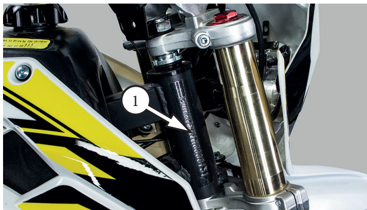
Фото 1.3. Место расположения серийного номера (VIN) – 1
