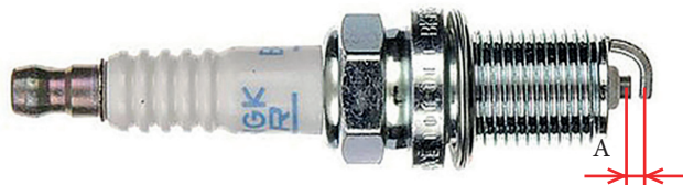
Фото 5.14. Зазор свечи зажигания – А
