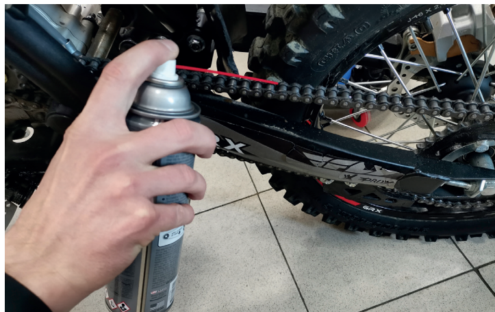
Фото 5.27. Очистка и смазка цепи
