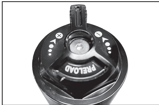
Фото 2.12 Регулятор предварительного натяжения
