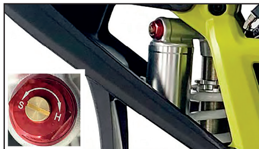
Фото 2.15 Винт регулировки сжатия
