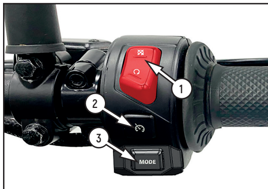
Фото 2.4 Правый рулевой блок для моделей EX2 и EX3: 1 – кнопка включения питания; 2 – кнопка включения функции круиз-контроля; 3 – кнопка входа в настройки приборной панели
