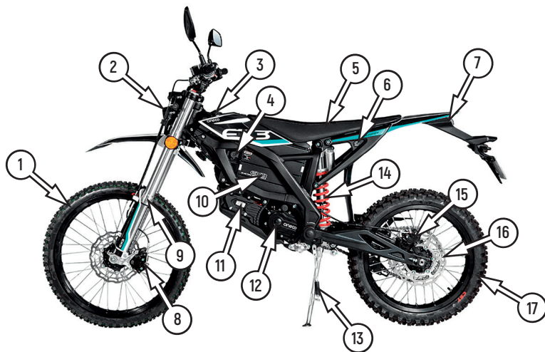
Фото 2.1.1 Левая сторона модели EX3: 1 - переднее колесо; 2 – фара; 3 - выключатель питания; 4 - порт для зарядки; 5 – подушка сиденья; 6 - замок сиденья; 7 - задний фонарь; 8 - передний тормозной суппорт; 9 - передний амортизатор; 10 – аккумулятор; 11 – контроллер; 12 – двигатель; 13 - боковая подставка; 14 - задний амортизатор; 15 - задний тормозной суппорт; 16 - задний тормозной диск; 17 - заднее колесо
