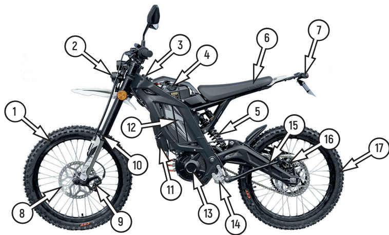
Фото 2.1 Левая сторона модели EX2: 1 – переднее колесо; 2 – фара; 3 – электрический выключатель; 4 – порт для зарядки; 5 – задний амортизатор; 6 – подушка сиденья; 7 – задний фонарь; 8 – передний тормозной диск; 9 – передний тормозной суппорт; 10 – передний амортизатор; 11 – контроллер; 12 – аккумулятор; 13 – двигатель; 14 – подножка; 15 – боковая подставка; 16 – задний тормозной суппорт; 17 – заднее колесо
