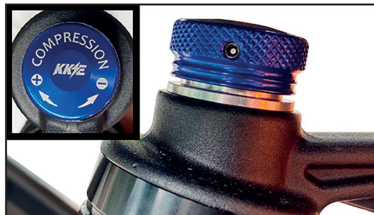
Фото 2.14 Винт регулировки сжатия
