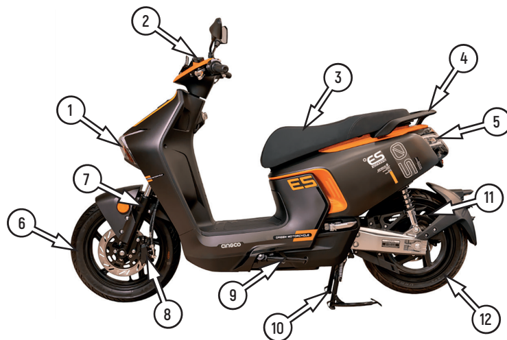
Фото 2.17 Правая сторона модели ES5: 1- фара; 2 - приборная панель; 3 - подушка сиденья; 4 - задний подлокотник; 5 - задний фонарь; 6 - переднее колесо; 7 - передний амортизатор; 8 - передний тормозной суппорт; 9 – боковая подставка; 10 – центральная подставка; 11 - приводной ремень; 12 - заднее колесо
