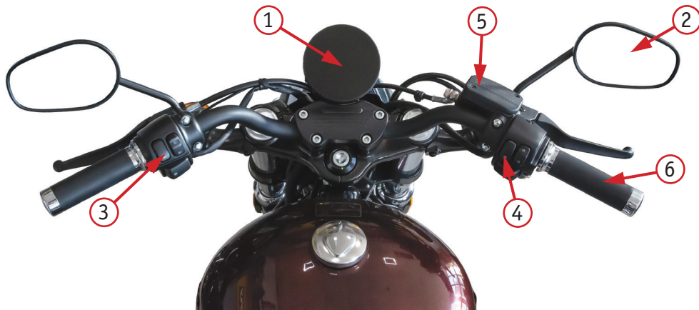
Фото 2.1. Вид руля и органов управления мотоцикла: 1 – приборная панель; 2 – зеркало заднего вида; 3 – левый комбинированный переключатель; 4 – правый комбинированный переключатель; 5 – бачок для тормозной жидкости; 6 – рукоятка газа (акселератор)
