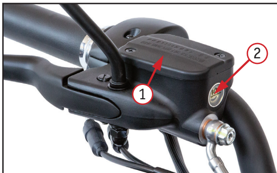
Фото 5.8 Уровень тормозной жидкости переднего тормоза: 1 –крышка; 2 – минимум
