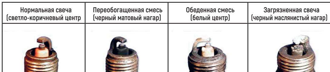
Фото 5.2. Состояния свечей зажигания
