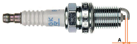
Фото 5.3. Зазор «А» между электродами свечи зажигания
