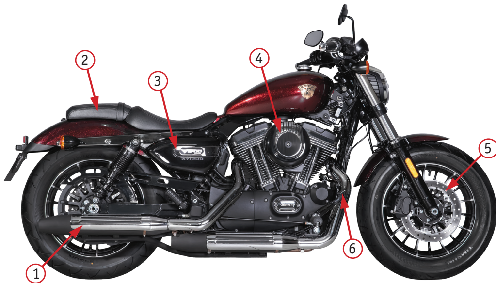
Фото 2.2. Вид справа: 1 – глушитель; 2 – сиденье; 3 – боковая панель (доступ к щупу и заливке масла); 4 – крышка воздушного фильтра; 5 – передний тормозной диск; 6 – педаль заднего тормоза
