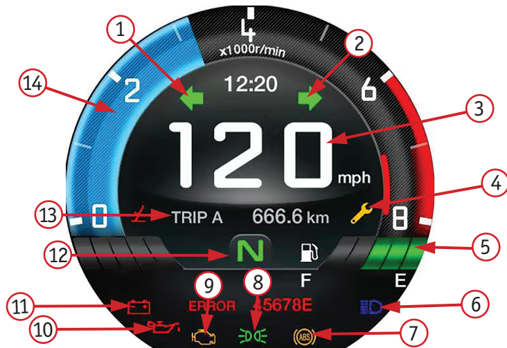
Фото 2.10. Вид приборной панели: 1 – индикатор левого поворотника; 2 – индикатор правого поворотника; 3 – скорость; 4 – индикатор технического обслуживания; 5 – количество топлива; 6 – индикатор дальнего света; 7 – индикатор ABS; 8 – индикатор габаритных огней; 9 – индикатор неисправности EFI; 10 – индикатор пониженного давления масла; 11 – индикатор пониженного напряжения батареи; 12 – индикатор нейтральной передачи; 13 – текущий/общий пробег; 14 – тахометр
