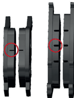
Фото 5.10. Определение износа тормозных колодок
