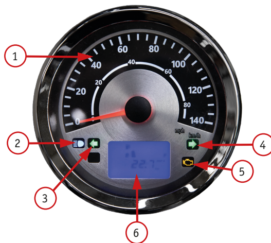
Фото 2.9. Вид приборной панели 1 – спидометр; 2 – индикатор дальнего света; 3 – левый поворотник; 4 – правый поворотник; 5 – индикатор неисправности EFI; 6 – ЖК-дисплей
