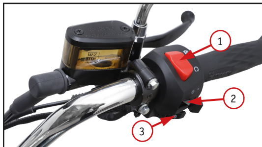
Фото 2.4. Правый комбинированный переключатель: 1 – кнопка включения/отключения питания; 2 – переключатель освещения; 3 – электростартер
