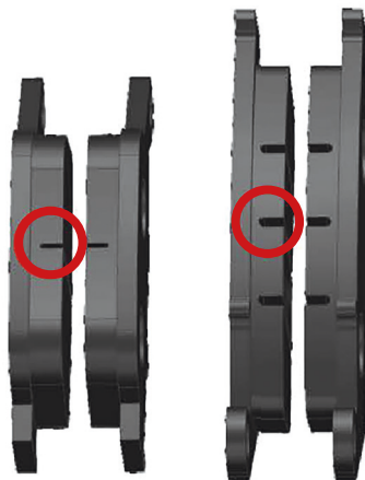
Фото 5.8. Определение износа тормозных колодок
