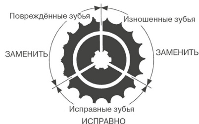
Рисунок 3. Износ звезд
