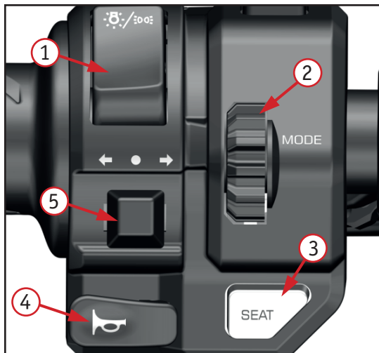
Фото 2.4. Левый блок переключателей: 1 – кнопка переключения режима света фар (ДХО/ближний свет); 2 – многофункциональная кнопка «MODE»; 3 – кнопка «SEAT»; 4 – кнопка звукового сигнала; 5 – переключатель указателей поворотов; 6 – кнопка включения аварийной сигнализации; 7 – переключатель режима света фары (дальний/ближний/при обгоне)
