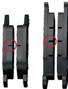
Фото 4.10. Износ тормозных колодок «А»
