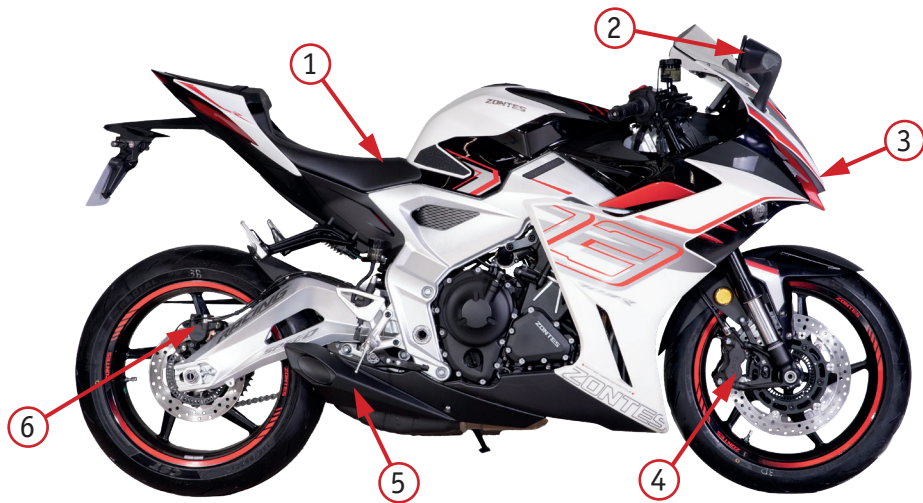
Фото 2.2. Вид справа: 1 – сиденье; 2 – зеркало заднего вида; 3 – передняя фара; 4 – передний тормозной суппорт; 5 – глушитель; 6 – задний тормозной суппорт
