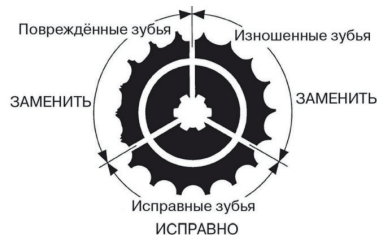
Рисунок 2. Износ звезд
