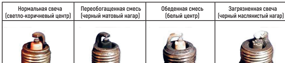
Фото 4.4. Состояния свечи зажигания
