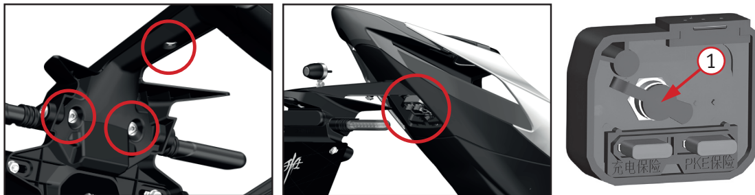
Фото 4.2 Место подключения зарядки АКБ: 1 – разъем зарядки
