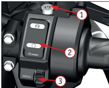
Фото 2.5. Правый блок переключателей: 1 – кнопка включения; 2 – выключатель зажигания; 3 – многофункциональная кнопка «MENU»
