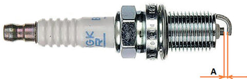
Фото 4.5. Зазор «А» между электродами свечи зажигания
