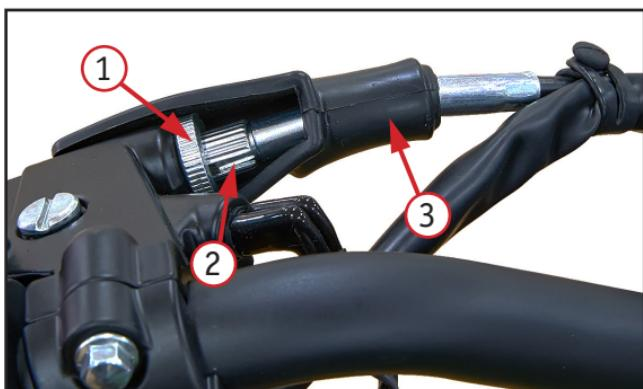
Фото 2.11. Регулировка сцепления:
