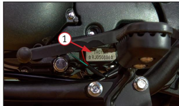
*Фото 1.2. Слева на картере нанесен серийный номер двигателя – 1*
