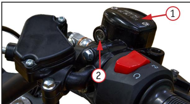
Фото 5.7.1 Уровень тормозной жидкости переднего тормоза: 1 – крышка; 2 – окно контроля уровня
