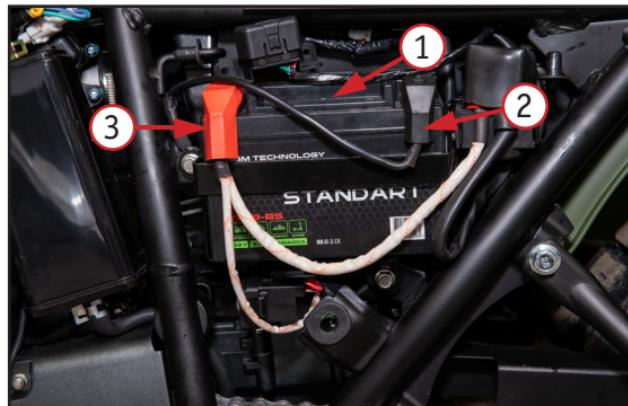
Фото 4. Аккумуляторный отсек: 1 – аккумуляторная батарея (АКБ); 2 – клемма «минус»; 3 – клемма «плюс»
