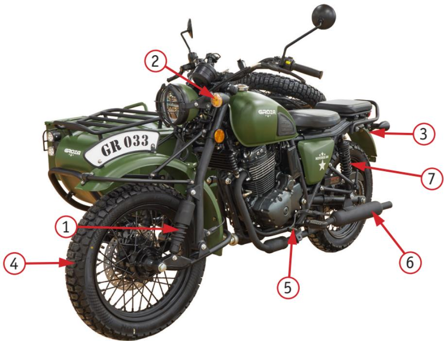
Фото 2.3. Вид слева: 1 – передний амортизатор; 2 – передний поворотный сигнал; 3 – крепление номерного знака; 4 – переднее колесо; 5 – латка переключения передач; 6 – глушитель; 7 – задний амортизатор
