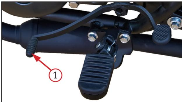
Фото 2.12. Рычаг переключения передач – 1
