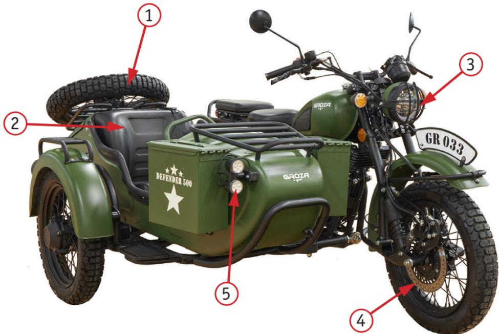
Фото 2.2. Вид справа: 1 – запасное колесо; 2 – сиденье коляски; 3 – фара; 4 – передний тормозной диск;
