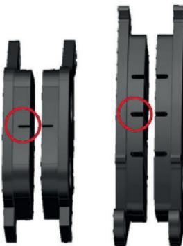
Фото 5.10. Определение износа тормозных колодок
