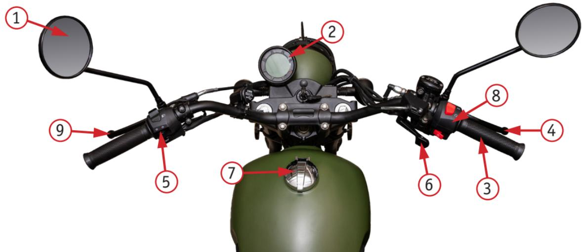
Фото 2.1. Вид руля и органов управления мотоцикла: 1 – зеркало заднего вида; 2 – приборная панель; 3 – ручка газа (акселератора); 4 - рычаг переднего тормоза; 5 – левый блок переключателей; 6 – рычаг включения задней передачи; 7 – крышка топливного бака; 8 – правый блок переключателей; 9 – рычаг сцепления
