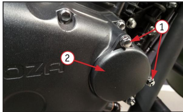
Фото 5.6. Болты крышки масляного фильтра – 1;
