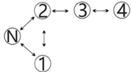
Рисунок 1. Схема переключения передач
