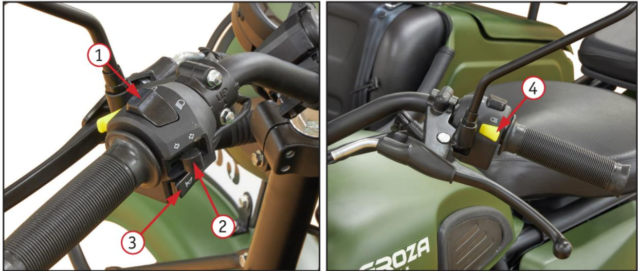
Фото 2.4. Левый комбинированный переключатель: 1 – кнопка переключения режима света фары (дальний свет/ближний свет); 2 – переключатель указателей поворота; 3 – кнопка звукового сигнала; 4 – кнопка включения дальнего света при обгоне
