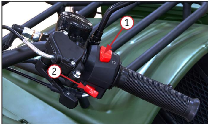
Фото 2.5 Правый комбинированный переключатель: 1 – переключатель включения/отключения питания;
