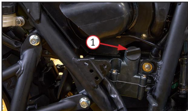
Фото 5.4. Пробка горловины для заливания масла – 1
