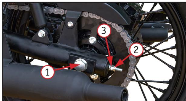
Фото 5.8 Регулировка цепи: 1 - гайка задней оси;
