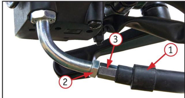
*Фото 3. Регулировка троса газа: 1 – защитный колпачок; 2 – стопорная гайка; 3 – регулировочная гайка*
