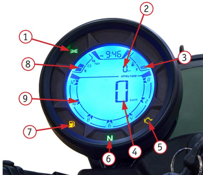
Фото 2.10. Вид приборной панели: 1 – индикатор габаритных огней; 2 – текущий/общий пробег; 3 – количество топлива; 4 – спидометр; 5 – индикатор неисправности EFI; 6 – индикатор нейтральной передачи; 7 – индикатор низкого уровня топлива; 8 – напряжение АКБ; 9 – тахометр
