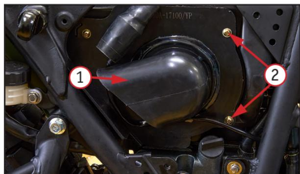
Фото 5.1. Обслуживание воздушного фильтра:
