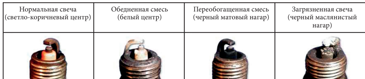
Фото 5.15. Состояния свечей зажигания
