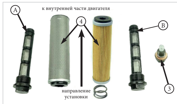
Фото 5.4.1. Замена масла в двигателях с масляным фильтром
