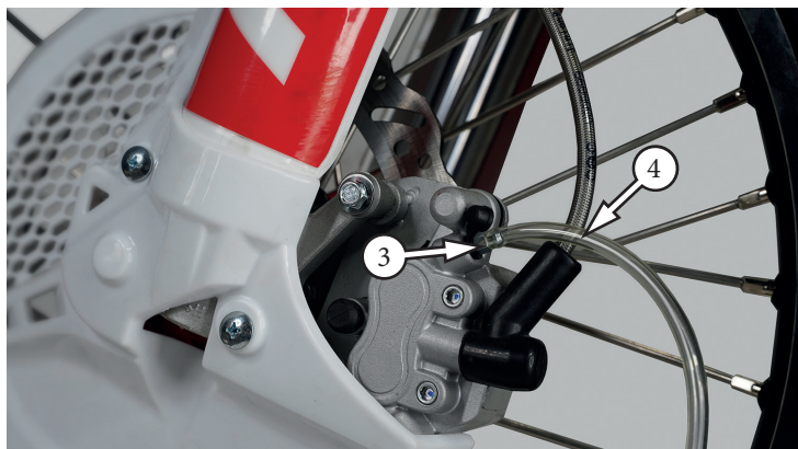
Фото 5.23. Прокачка тормозной системы
