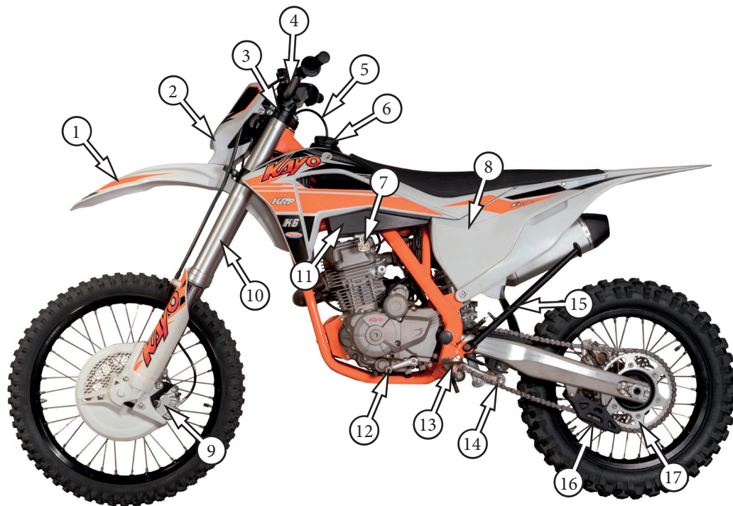
Фото 2.1. Левая сторона мотоцикла (вариант): 1 – переднее крыло; 2 – передний щиток; 3 – верхняя траверса; 4 – руль; 5 – вентиляционная трубка; 6 – крышка бака; 7 – топливный кран; 8 – крышка доступа к воздушному фильтру; 9 – передний тормозной суппорт; 10 – передняя вилка; 11 – топливный бак; 12 – рычаг переключения передач; 13 – левая подножка водителя; 14 – цепь; 15 – боковая подставка; 16 – направляющая цепи; 17 – задняя звездочка
