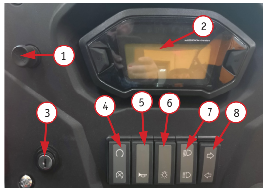
Фото 2.5. Органы щитка управления: 1 – рычаг обогащения топливной смеси; 2 – приборная панель; 3 – замок зажигания; 4 – выключатель электропитания; 5 – клавиша звукового сигнала; 6 – клавиша включения освещения; 7 – клавиша переключения дальнего/ближнего режима работы фары; 8 – клавиша включения указателей поворотов
