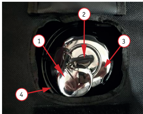
Фото 3.13. Заправка топливом: 1 – защитная крышка; 2 – ключ; 3 – крышка топливного бака; 4 – топливный бак
