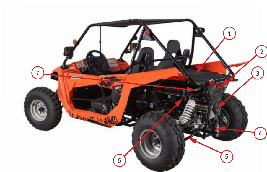
Фото 2.4. Вид квадрицикла сзади: 1 – топливный бак; 2 – фара стоп-сигнала; 3 – глушитель; 4 – прицепное устройство; 5 – рама подвески заднего колеса; 6 – двигатель ; 7 – задний указатель поворота
