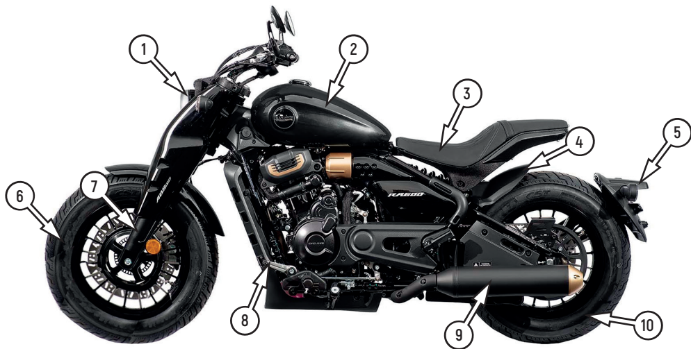
Фото 2.2.1. Вид слева: 1 – передняя фара; 2 – топливный бак; 3 – сиденье; 4 – крыло заднее; 5 – задний фонарь; 6 – переднее колесо; 7 – передняя вилка; 8 – рычаг переключения передач; 9 – глушитель; 10 – заднее колесо
