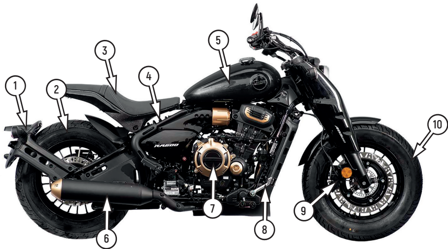
Фото 2.2.2. Вид справа: 1 – фонарь освещения номерного знака; 2 – заднее колесо; 3 - сиденье; 4 – задний амортизатор; 5 - накладка топливного бака; 6 – глушитель; 7 – двигатель; 8 - рычаг заднего тормоза; 9 - передний тормозной суппорт; 10 - переднее колесо
