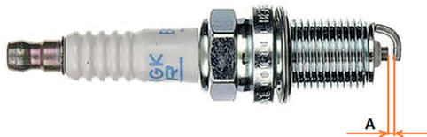
Фото 5.3. Зазор «А» между электродами свечи зажигания
