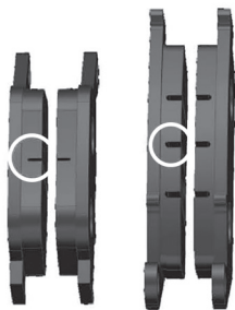
Фото 5.9. Определение износа тормозных колодок
