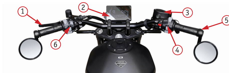
Фото 2.1. Вид руля и органов управления мотоцикла: 1 – рычаг сцепления; 2 – приборная панель; 3 – бачок для тормозной жидкости; 4 – правый комбинированный переключатель; 5 – рычаг переднего тормоза; 6 – левый комбинированный переключатель
