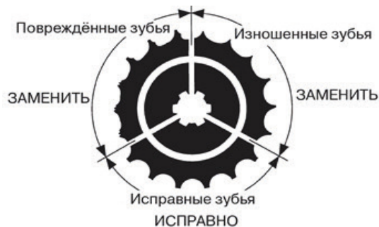
Рисунок 4. Износ звезд.
