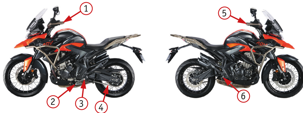
Фото 4.11. Элементы регулярной смазки: 1 – рычаг сцепления; 2 – боковая подножка с пружиной; 3 – ось рычага переключения передач и левая подножка водителя; 4 – цепь привода; 5 – рычаг тормоза; 6 – правая подножка водителя.
