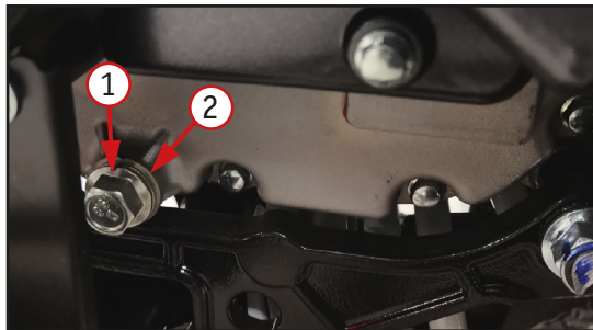
Фото 4.5. Слив моторного масла: 1 - сливной болт; 2 - шайба.
