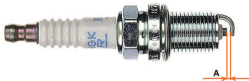
Фото 4.4. Зазор между электродами свечи зажигания.
