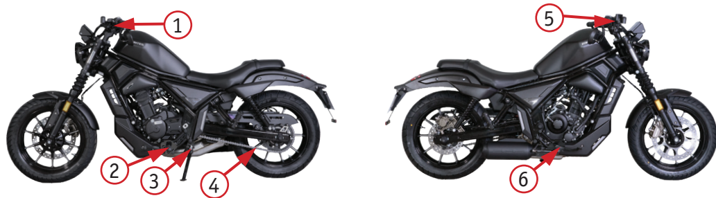
Фото 4.10. Элементы регулярной смазки: 1 – рычаг сцепления; 2 – левая подножка водителя; 3 – боковая подножка с пружиной; 4 – приводная цепь; 5 – рычаг тормоза; 6 – правая подножка водителя
