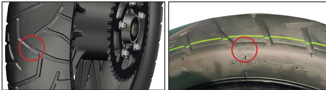
Фото 3.11. Расположение меток износа шины
