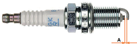
Фото 4.4. Зазор между электродами свечи зажигания
