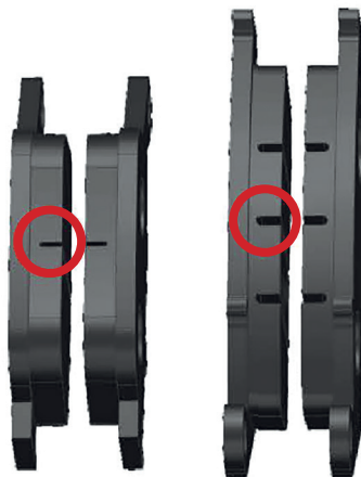
Фото 5.10. Определение износа тормозных колодок
