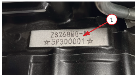
Фото 1.1. Справа на двигателе нанесен серийный номер двигателя - 1
