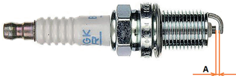
Фото 4.5. Зазор «А» между электродами свечи зажигания
