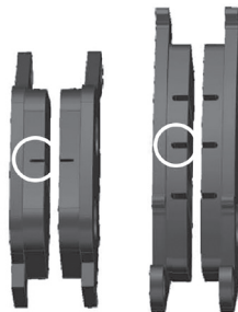
Фото 4.11. Канавки износа тормозных колодок
