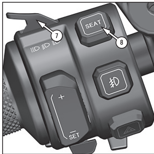
Фото 2.4.1. Левый блок переключателей модели 368E-G: 1 – переключатель круиз-контроля «+/SET»; 2 – кнопка включения противотуманных фар; 3 – кнопка аварийной сигнализации; 4 – переключатель указателей поворота; 5 – кнопка звукового сигнала; 6 – кнопка «ОК»; 7 - кнопка переключения режимов света фары (дальний/ближний); 8 – кнопка открывания сиденья
