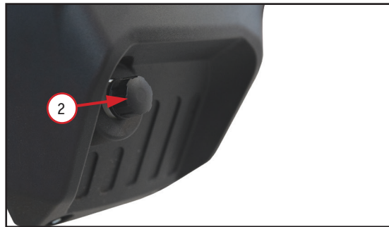
Фото 5.7. Замена охлаждающей жидкости: 1 – крышка радиатора; 2 – крышка бачка
