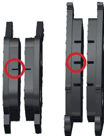
Фото 5.10. Определение износа тормозных колодок
