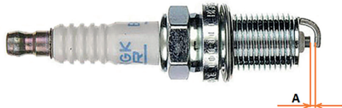
Фото 5.3. Зазор «А» между электродами свечи зажигания
