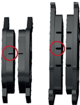
Фото 5.9. Определение износа тормозных колодок
