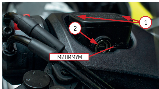
Фото 5.8.1. Бачок тормозной жидкости передних тормозов: 1 – винты крепления крышки бачка; 2 – смотровое окно
