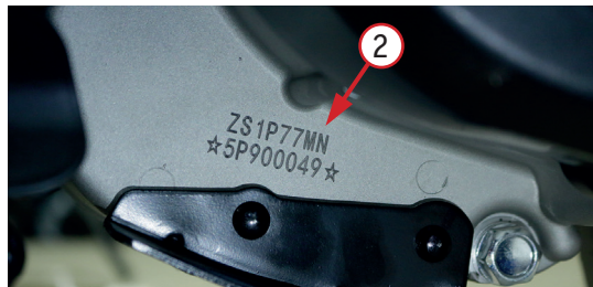
Фото 1.2. Заводской номер двигателя 2 нанесен слева на картере
