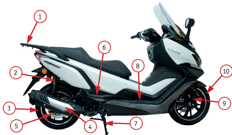
Фото 2.2. Вид скутера справа: 1 – задняя грузовая полка; 2 – задний амортизатор; 3 – заднее колесо; 4 – глушитель; 5 – задний дисковый тормоз; 6 – задняя правая подножка для пассажира; 7 – центральная подставка; 8 – правая передняя площадка для ноги водителя; 9 – правый передний амортизатор; 10 – переднее колесо
