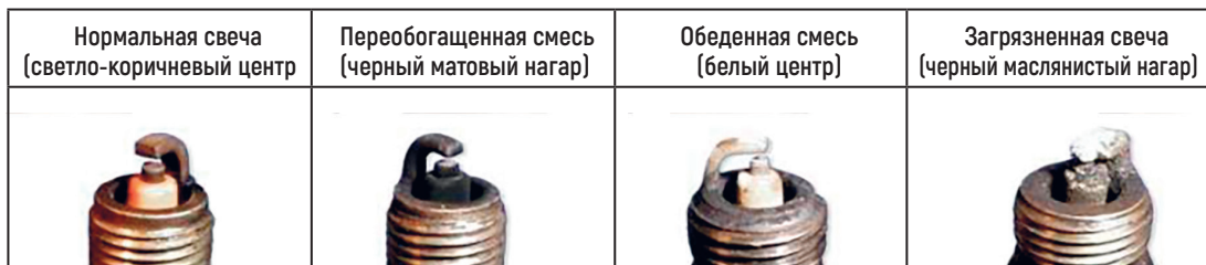
Фото 5.9. Состояния свечи зажигания
