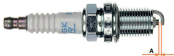
Фото 5.16. Зазор между электродами свечи зажигания
