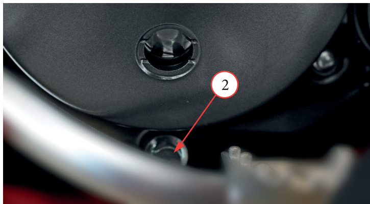
Фото 5.3.1. Сливной болт в двигателе LX1E66MM (MT-250 2T)
