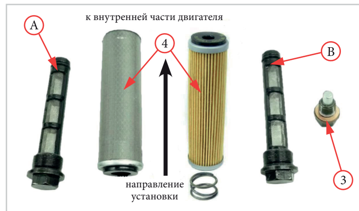
Фото 5.4.1. Замена масла в двигателях с масляным фильтром
