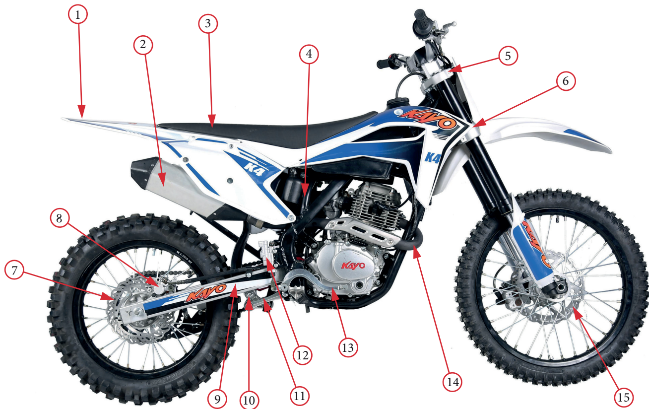
Фото 2.2. Правая сторона мотоцикла: 1 – заднее крыло; 2 – глушитель; 3 – сиденье; 4 – задний амортизатор; 5 – верхний зажим; 6 – нижний зажим; 7 – тормозной диск заднего тормоза; 8 – задний тормозной суппорт; 9 – маятник; 10 – треугольное коромысло; 11 – U-образное коромысло; 12 – задний тормозной цилиндр; 13 – педаль заднего тормоза; 14 – выхлопной патрубкок; 15 – диск переднего тормоза
