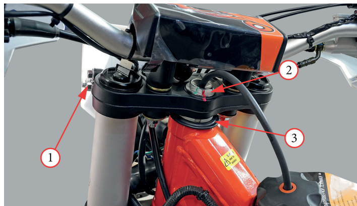
Фото 5.33. Регулировка подшипников рулевой колонки
