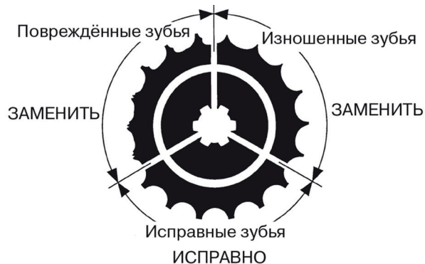
Рисунок 5.27. Вид зубьев звездочки
