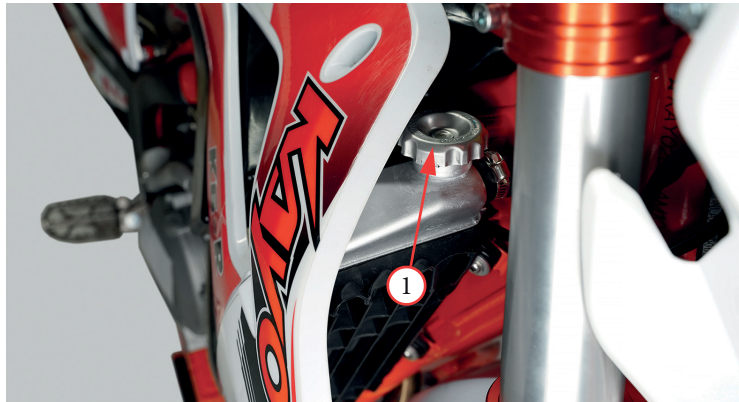
Фото 5.6. Контроль уровня охлаждающей жидкости
