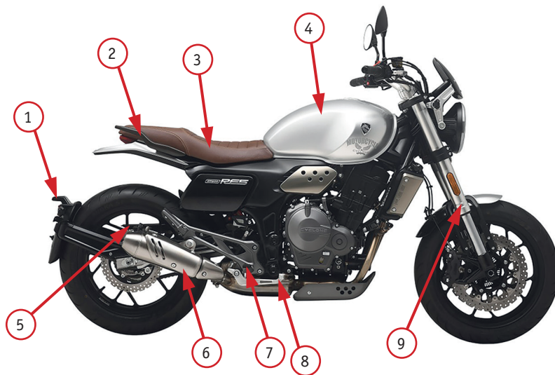
Фото 2.2.2 Вид справа: 1 – фонарь освещения номерного знака; 2 – поручень правый пассажирский; 3 – сиденье; 4 – накладка топливного бака; 5 - задний тормозной суппорт; 6 - глушитель; 7 – правая подножка водителя; 8 – рычаг заднего тормоза; 9 - передний амортизатор
