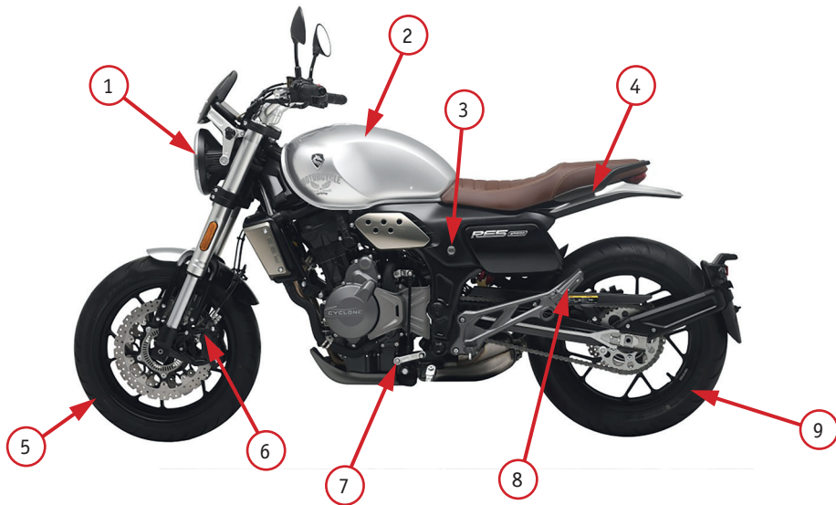
Фото 2.2.1 Вид слева: 1 – передняя фара; 2 – топливный бак; 3 – замок сиденья; 4 – поручень левый пассажирский; 5 – переднее колесо; 6 – передний тормозной суппорт; 7 – рычаг переключения передач; 8 – левая подножка пассажира; 9 – заднее колесо
