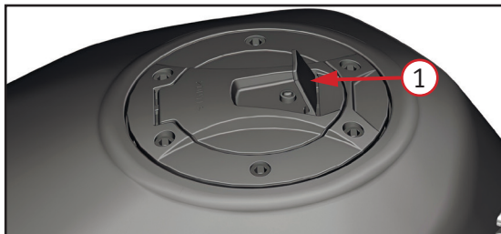
Фото 3.7. Топливный бак: 1 – защитная створка (язычок); 2 – крышка
