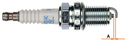
Фото 4.4. Зазор между электродами свечи зажигания
