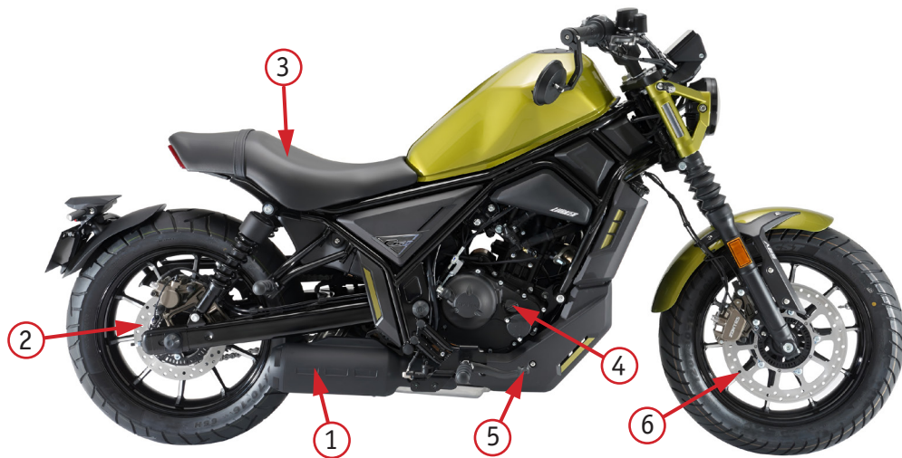
Фото 2.2. Вид справа: 1 – глушитель; 2 – задние дисковые тормоза; 3 – сиденье; 4 – заливная горловина для масла; 5 – педаль заднего тормоза; 6 – передние дисковые тормоза
