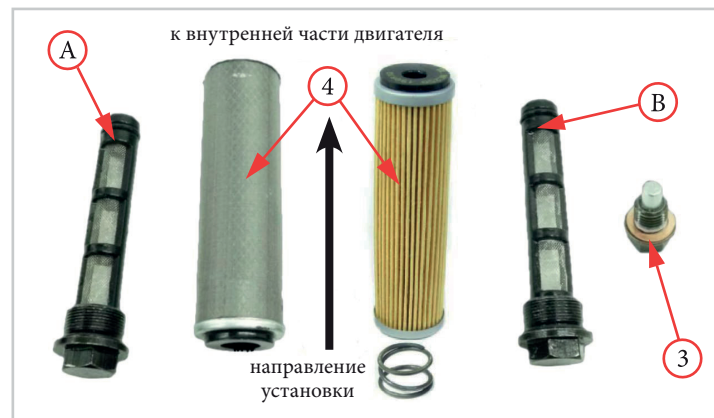
Фото 5.4.1. Замена масла в двигателях с масляным фильтром
