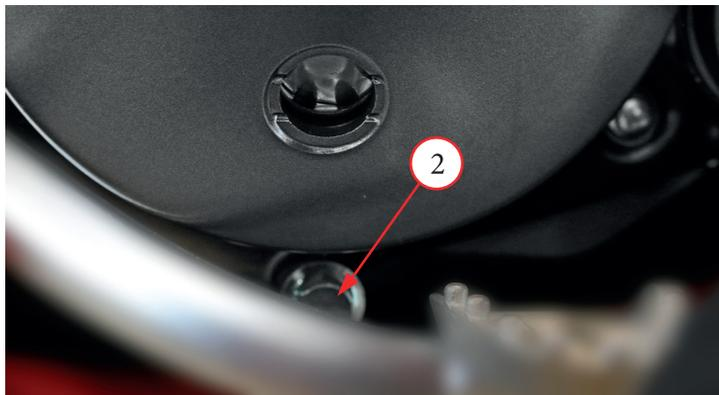
Фото 5.3.1. Сливной болт в двигателе LX1E66MM (MT-250 2T)
