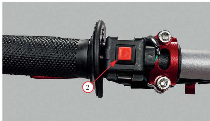
Фото 3.5.2. Кнопка остановки двигателя – 2
