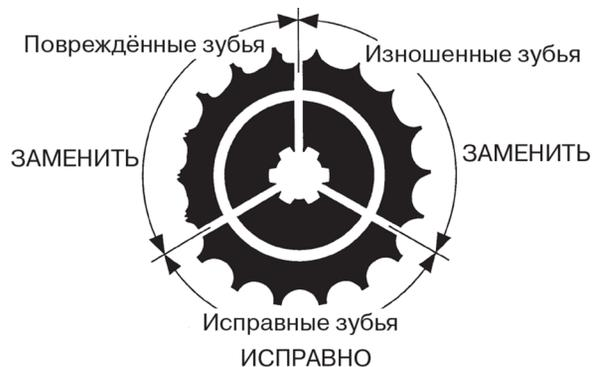
Рисунок 5.27. Вид зубьев звездочки
