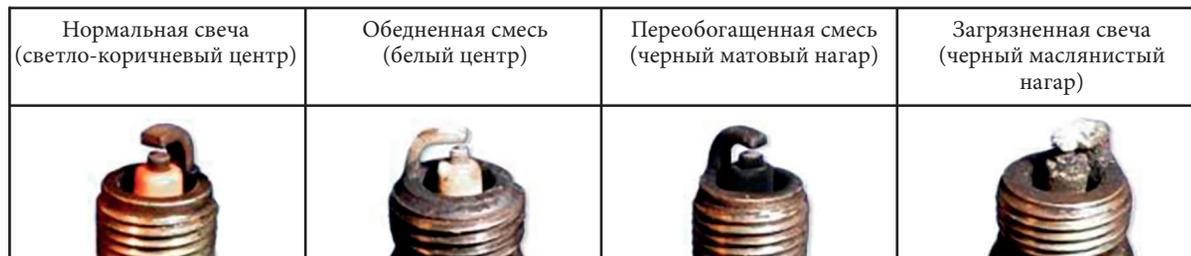
Фото 5.15. Состояния свечей зажигания
