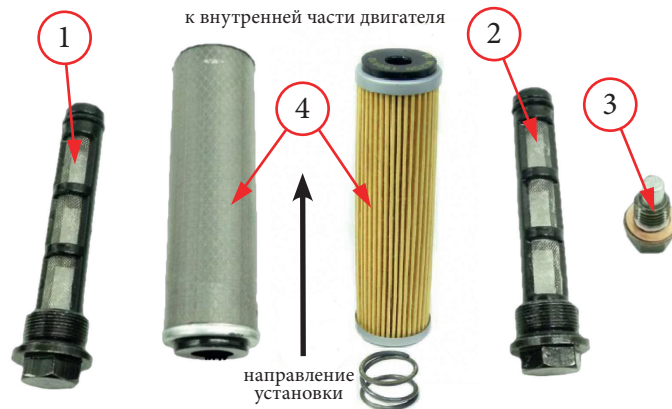
Фото 5.5.2. Части масляного фильтра
