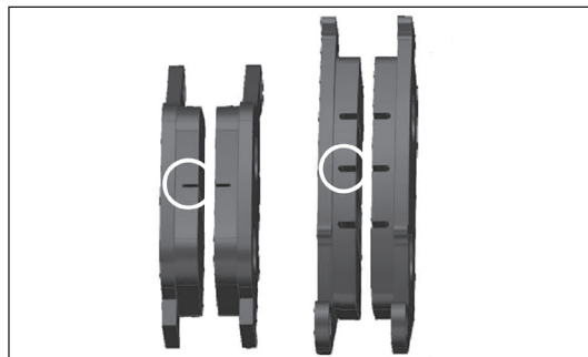
Рисунок 2. Канавки износа тормозных колодок
