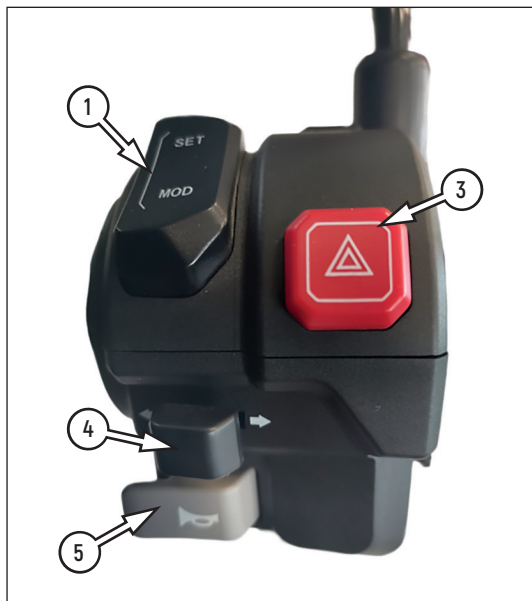
Фото 2.4 Левый блок переключателей: 1 – переключатель входа в основное меню «MOD-SET»; 2 – переключатель режимов света фары (дальний/ближний); 3 – кнопка аварийной сигнализации; 4 – переключатель указателей поворота; 5 – кнопка звукового сигнала; 6 – кнопка открывания сиденья
