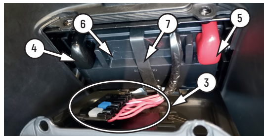
Фото 4.1 Аккумуляторный отсек: 1 – винты крепления крышки; 2 – крышка отсека; 3 – блок предохранителей; 4 – черный защитный колпачок; 5 – красный защитный колпачок; 6 – аккумулятор; 7 – крепежный ремень
