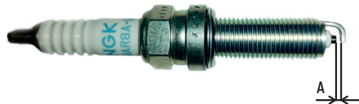
Фото 4.5 Зазор «А» между электродами свечи зажигания
