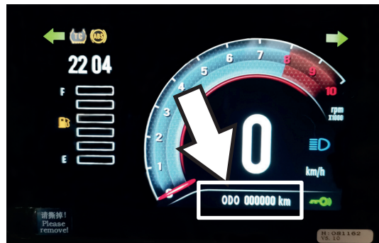
Фото 2.8.1 Место вывода индикации дополнительных элементов (внизу панели)
