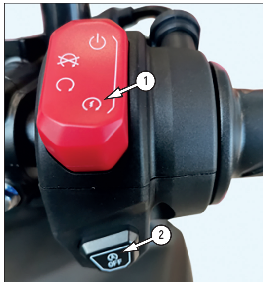
Фото 2.5 Правый блок переключателей: 1 – кнопка включения/отключения питания двигателя; 2 – кнопка автоматического включения/отключения запуска и остановки на холостом ходу («start-stop»)
