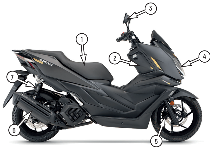
Фото 2.2 Вид справа: 1 – сиденье; 2 – правый ящик; 3 – зеркало заднего вида; 4 – передняя фара; 5 – передний тормозной суппорт; 6 – глушитель; 7 – задний амортизатор
