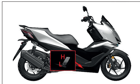
Фото 2.11.1 Метки уровня охлаждающей жидкости: H – максимум; L – минимум
