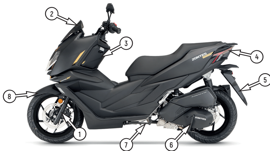
Фото 2.3 Вид слева: 1 – передние амортизаторы; 2 – ветровое стекло; 3 – левый ящик; 4 – задний фонарь; 5 – заднее крыло; 6 – центральная подставка скутера; 7 – боковая подставка; 8 – переднее крыло
