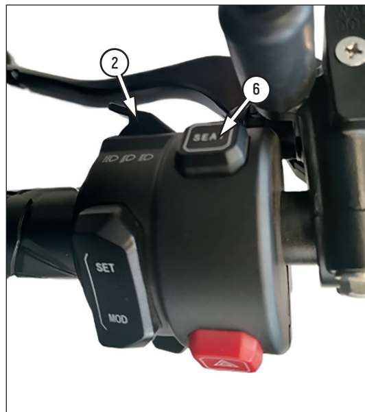
Фото 2.4 Левый блок переключателей: 1 – переключатель входа в основное меню «MOD-SET»; 2 – переключатель режимов света фары (дальний/ближний); 3 – кнопка аварийной сигнализации; 4 – переключатель указателей поворота; 5 – кнопка звукового сигнала; 6 – кнопка открывания сиденья
