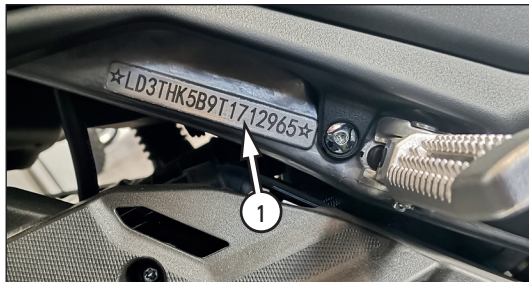
Фото 1.1 Место размещения VIN номера – 1
