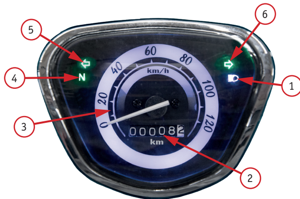
Фото 2.8. Вид приборной TFT-панели: 1 – индикатор дальнего света; 2 – одомер; 3 – спидометр; 4 – индикатор нейтрالي; 5 – левый поворотник; 6 – правый поворотник
