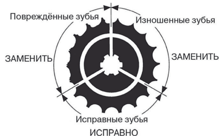
Рисунок 2. Износ звезд
