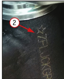
Фото 1.1. Бирка с серийным номером и годом выпуска – 1, расположена на нижней части рамы. Надпись с VIN номером – 2 нанесена на рулевом стакане.
