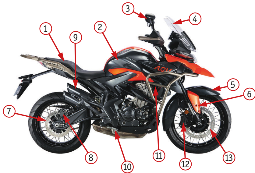
Фото 2.2. Вид справа: 1 – сиденье; 2 – топливный бак; 3 – зеркало заднего вида; 4 – ветровое стекло; 5 – крыло переднего колеса; 6 – защита правого педа; 7 – задний тормозной диск; 8 – задний тормозной суппорт; 9 – глушитель; 10 – педаль заднего тормоза; 11 – катушка зажигания; 12 – передний тормозной диск; 13 – передний тормозной диск.
