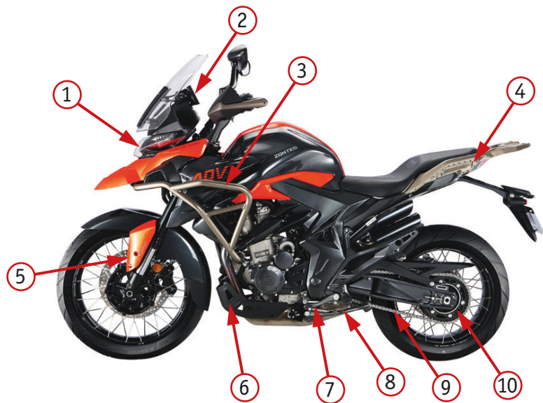
Фото 2.3. Вид слева: 1 – передняя фара; 2 – приборная панель; 3 – элементы защиты; 4 – заднее крыло; 5 – защита левого педала; 6 – защита картера; 7 – рычаг переключения передач; 8 – боковая подножка; 9 – приводная цепь; 10 – ведомая звезда.
