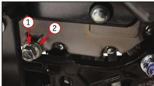
Фото 4.5. Слив моторного масла: 1 - сливной болт; 2 - шайба.
