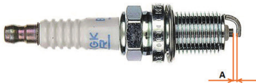
Фото 4.4. Зазор между электродами свечи зажигания.
