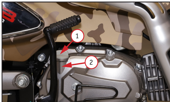
Фото 5.1. Контроль: 1 –щуп контроля уровня масла; 2 – заливная горловина
