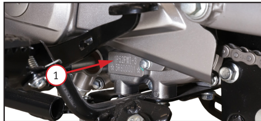
Фото 1.2. Слева на картере нанесен серийный номер двигателя 2
