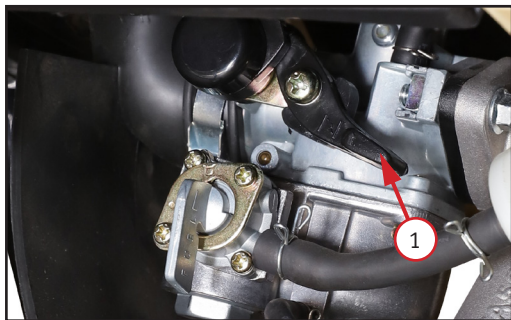
Фото 3.2. Рычаг воздушной заслонки (обогащения топливной смеси) – 1
