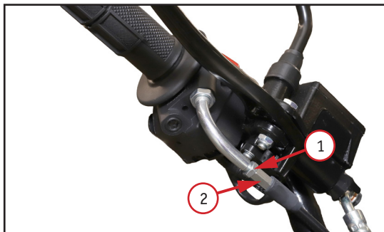
Фото 5.4. Регулировка троса газа: 1 – стопорная гайка; 2 – регулировочная гайка
