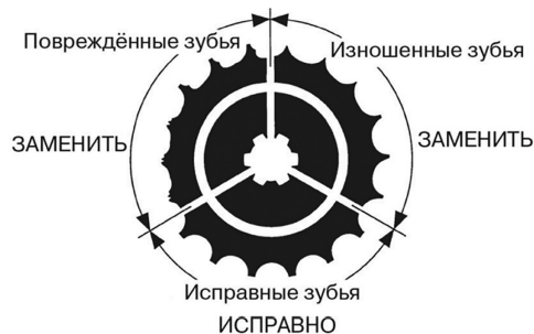
Рисунок 2. Вид зубьев звездочки
