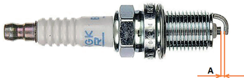
Фото 4.4. Зазор между электродами свечи зажигания
