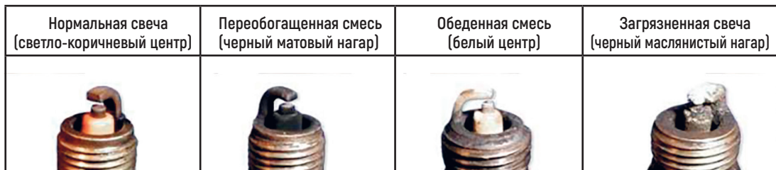
Фото 4.3. Состояния свечей зажигания
