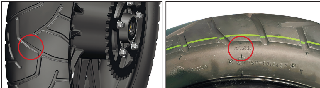
Фото 3.11. Расположение меток износа шины
