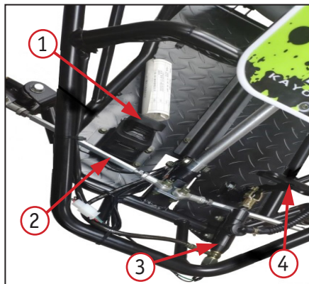
Фото 2.6. Органы управления модели eS70: 1 – педаль скорости; 2 – рулевая тяга; 3 – тормозной цилиндр; 4 – педаль тормоза
