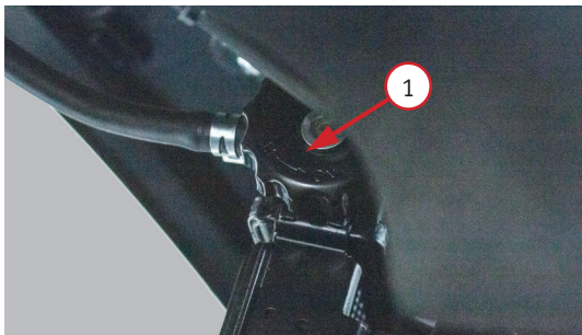
Фото 5.7. Замена охлаждающей жидкости: 1 – крышка радиатора; 2 – крышка бачка
