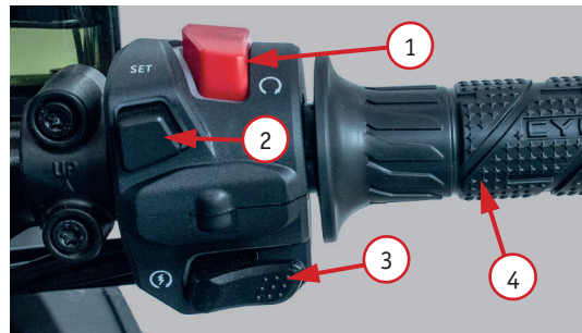
Фото 2.4. Правый комбинированный переключатель: 1 – включения/отключения питания; 2 - кнопка настройки панели (аналогична кнопки на левом блоке); 3 – электростартер; 4 – ручка газа (акселератора)
