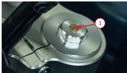
Фото 2.14. Регулировка демпфирования переднего и заднего амортизатора: регулировочный винт 1
