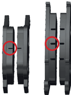
Фото 5.9. Определение износа тормозных колодок
