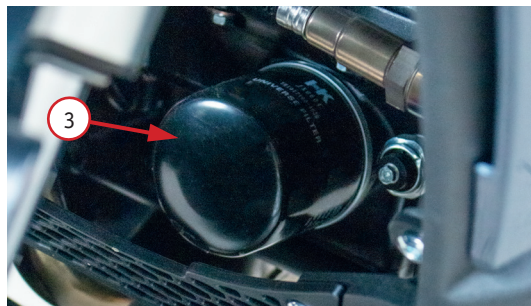
Фото 5.6. Замена масляного фильтра 3
