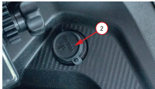
Фото 5.7. Замена охлаждающей жидкости: 1 – крышка радиатора; 2 – крышка бачка
