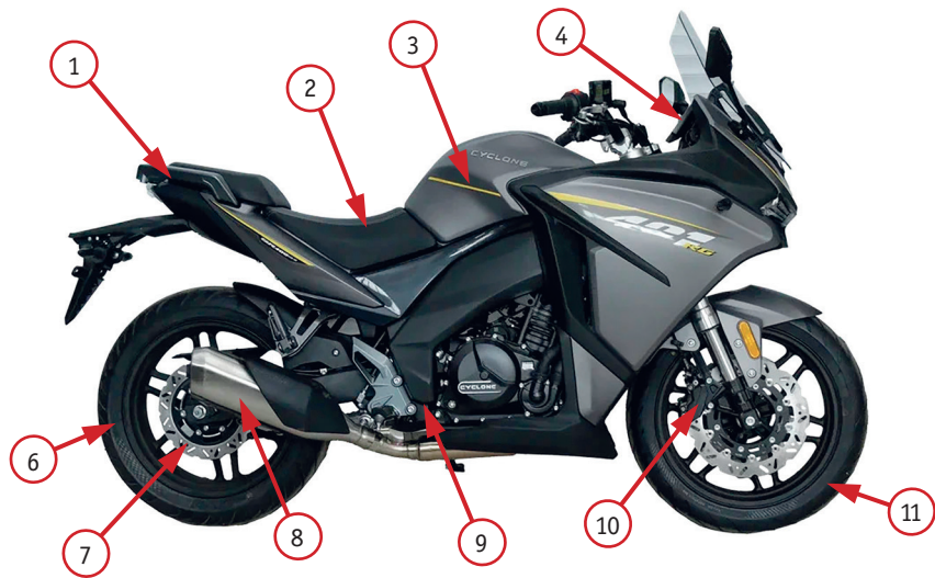
Фото 2.2. Вид мотоцикла справа: 1 - задний пассажирский поручень; 2 - сиденье; 3 - топливный бак; 4 - приборная панель; 5 - передняя фара; 6 - заднее колесо; 7 - задний тормозной диск; 8 - глушитель; 9 - рычаг заднего тормоза; 10 - передний тормозной суппорт; 11 - переднее колесо
