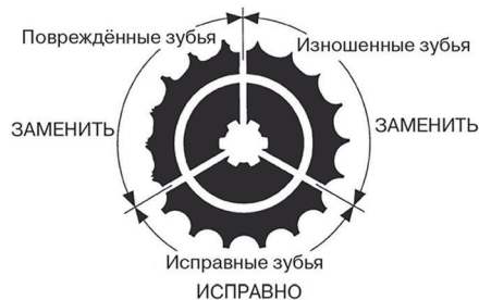
Рисунок 2. Износ звезд
