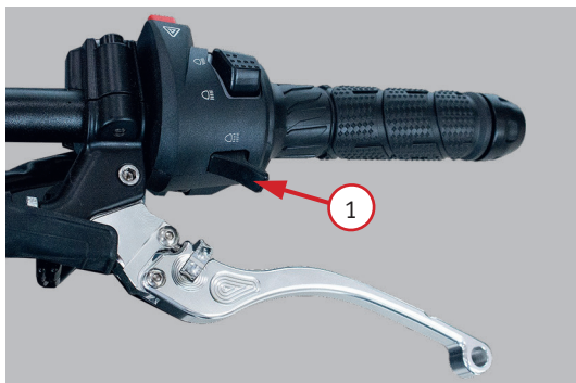
Фото 2.3. Левый комбинированный переключатель: 1 – кнопка включения дальнего света при обгоне; 2 – кнопка переключения режима света фары (дальний свет/ближний свет); 3 – кнопка звукового сигнала; 4 – кнопка указателей поворота; 5 – кнопка включения аварийной сигнализации; 6 – кнопка «MODE» (функции приборной панели); 7 – кнопка «SET» (функции приборной панели)
