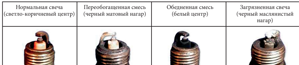
Фото 5.13. Состояния свечи зажигания
