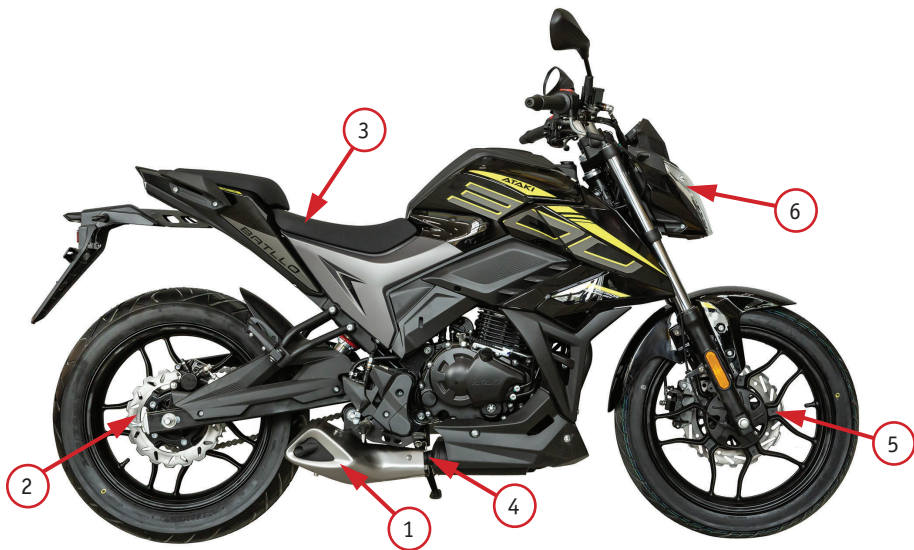
Фото 2.2. Вид справа: 1 – глушитель; 2 – задние дисковые тормоза; 3 – сиденье; 4 – педаль заднего тормоза; 5 – передние дисковые тормоза; 6 – фара
