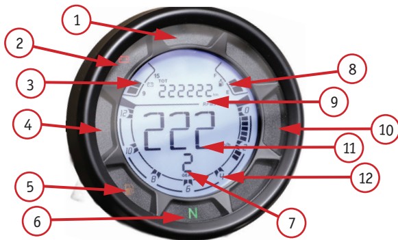
Фото 2.9.1 Вид приборной панели модели Week9: 1 - индикатор дальнего света; 2 – индикатор низкого напряжения аккумулятора; 3 –напряжение аккумулятора; 4 – индикатор левого поворотника; 5 – индикатор низкого уровня топлива; 6 – индикатор нейтральной передачи; 6 – индикатор нейтральной передачи; 7 – индикатор передачи; 8 – количество топлива; 9 – пробег; 10 – индикатор правого поворотника; 11 – спидометр; 12 – тахометр
