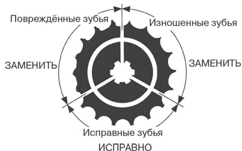
Рисунок 2. Вид зубьев звездочки
