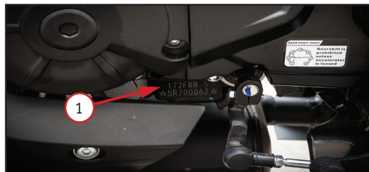
Фото 1.2. Слева на картере нанесен серийный номер двигателя 1
