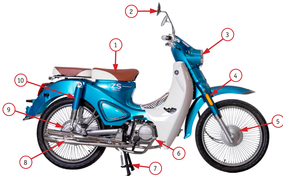
Фото 2.2. Вид мотоцикла: 1 – сиденье водителя; 2 – зеркало; 3 – фара; 4 – передний амортизатор; 5 – передний тормозной барабан; 6 – педаль заднего тормоза; 7 – центральная подставка; 8 – глушитель; 9 – задний тормозной барабан; 10 – задний амортизатор
