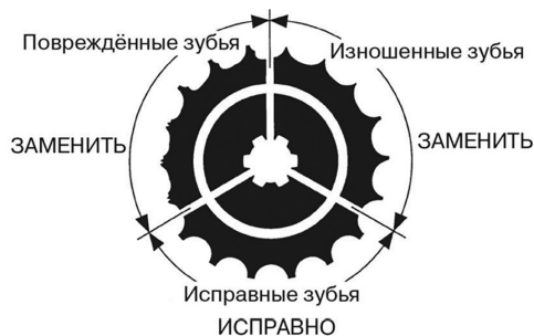
Рисунок 3. Вид зубьев звездочки
