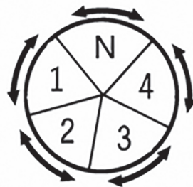
Рисунок 1. Схема переключения передач
