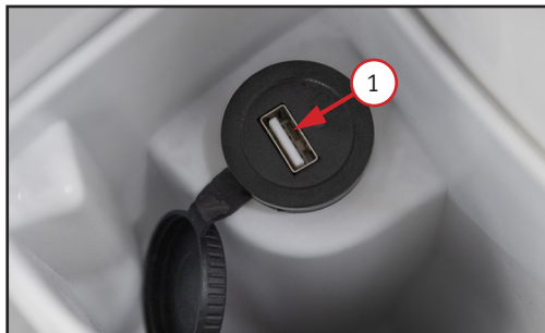
Фото 2.7. Порт USB для подключения внешних устройств: 1 – порт с USB-разъемом
